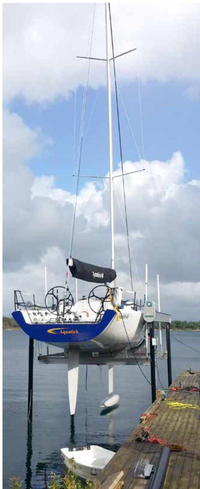
Superlift montert på pæler, 8 tonn.
