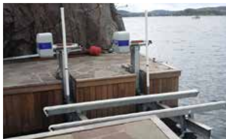
Elevatorlift med selvjusterende nivåregulering
