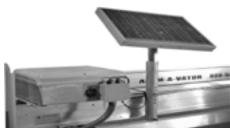
Solcelle drift av båtliften
