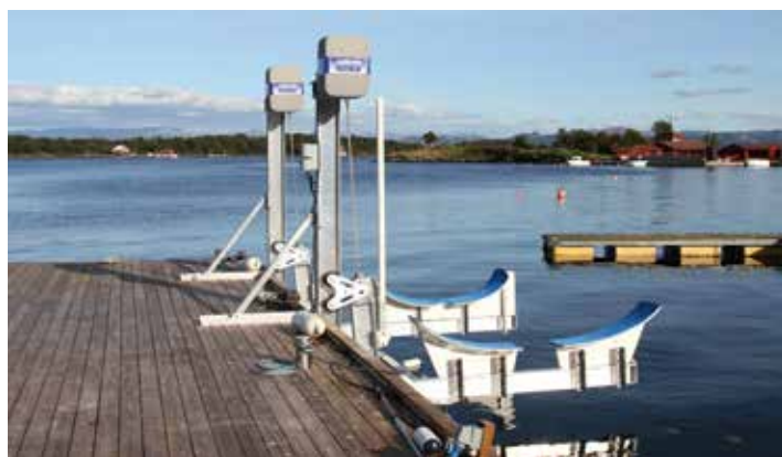
Elevatorlift 3600 kg, påmontert seilbåtkrybbe
